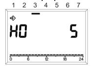
Установите левую ручку (ВЫБОР) в положение **MODE**, затем с помощью ручки (ИЗМЕНЕНИЕ) выберите **HO**, а затем, с помощью той же самой ручки задайте требуемое количество дней отпуска.
